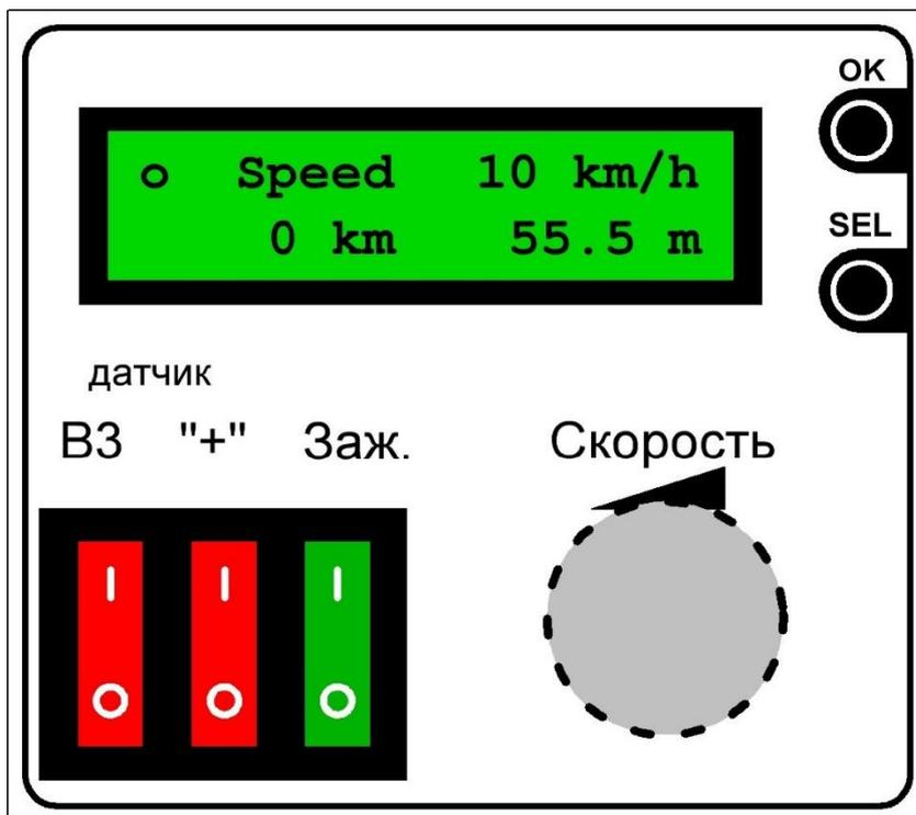
Выбор режима работы стенда производится с помощью клавиши «sel». При нажатии на неё происходит цикличное переключение предустановленных режимов работы. Подтверждается выбор режима нажатием клавиши «ok».
